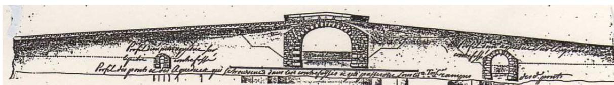
*Dessin de l'atelier Règemorte. Sur le canal du Loing : Le fossé passe sous l'arche de droite. Le contre-fossé passe à gauche sous l'arche plus petite*
