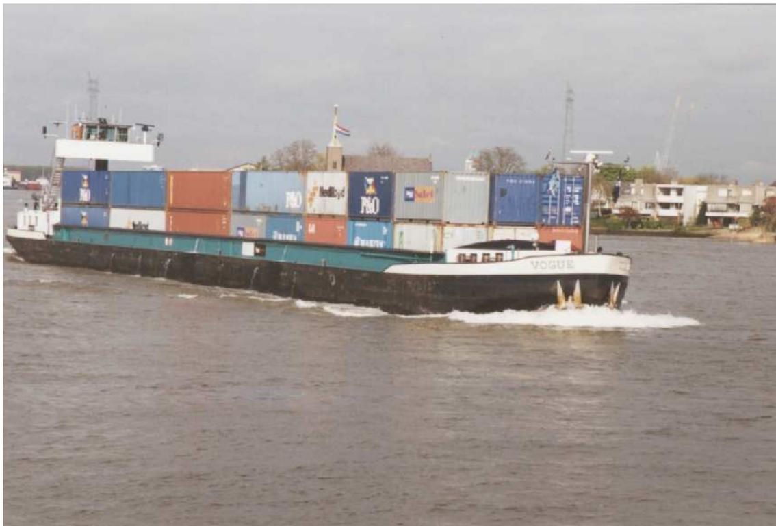
*Les bateaux de 110 m dépassent 2000 t portant 3 rangs de conteneurs. Vers 2005 apparaissent les bateaux de 135 m.*
