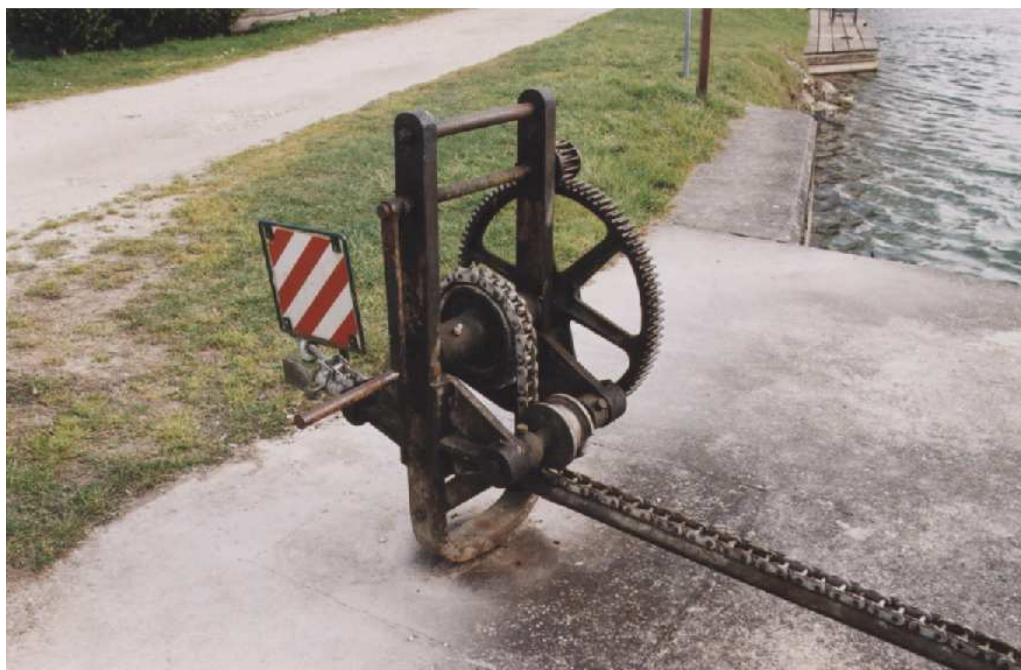
Treuil de l'écluse de Thouerat (F 16) sur la Charente.
