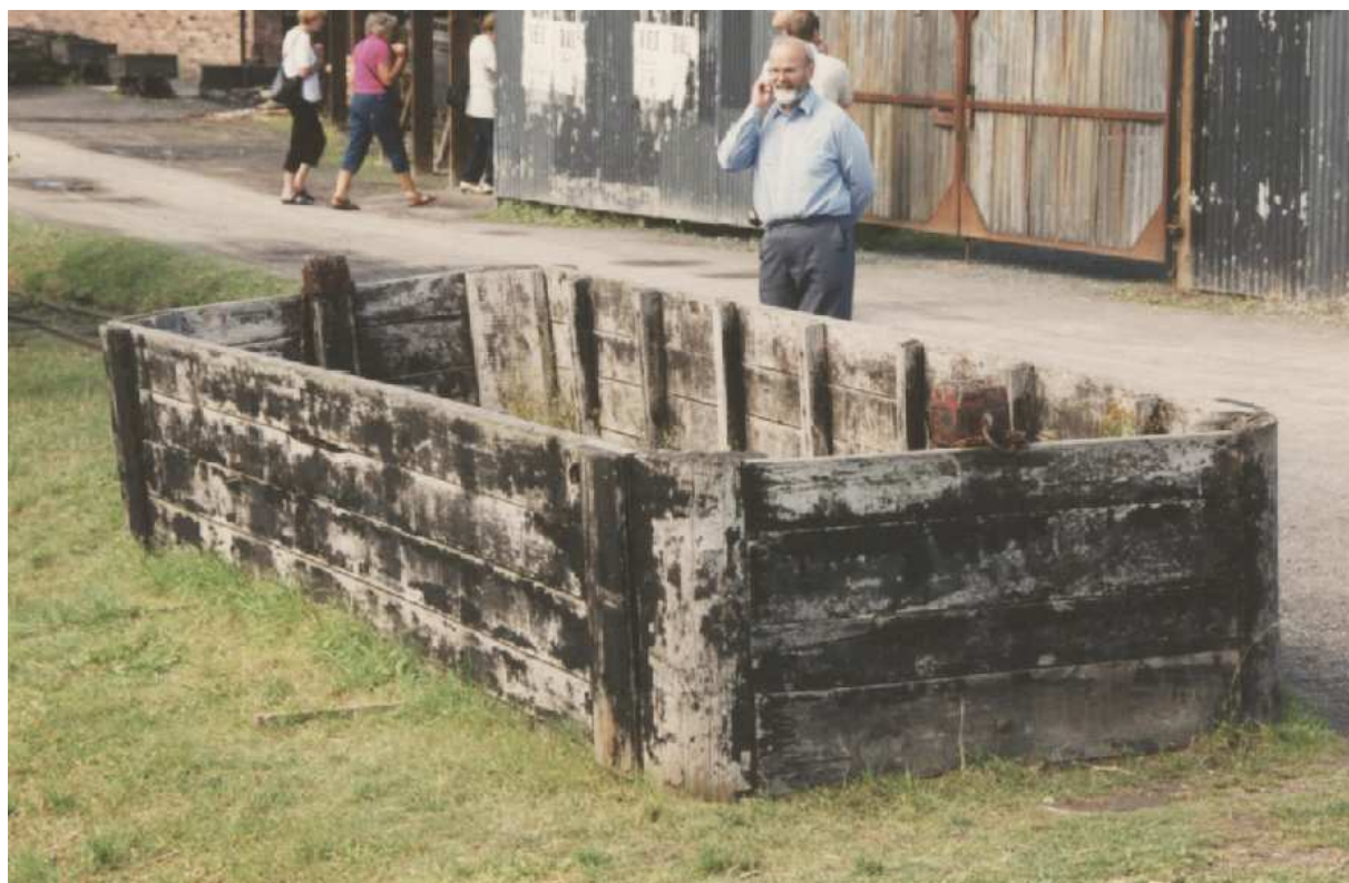
Les plans inclinés montaient des « tub boats » construits en bois, à l'origine puis en fonte.
