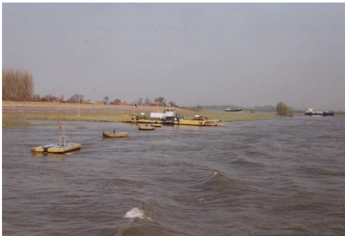
Alignement des batelets de la traile de Pannerden (NL)
