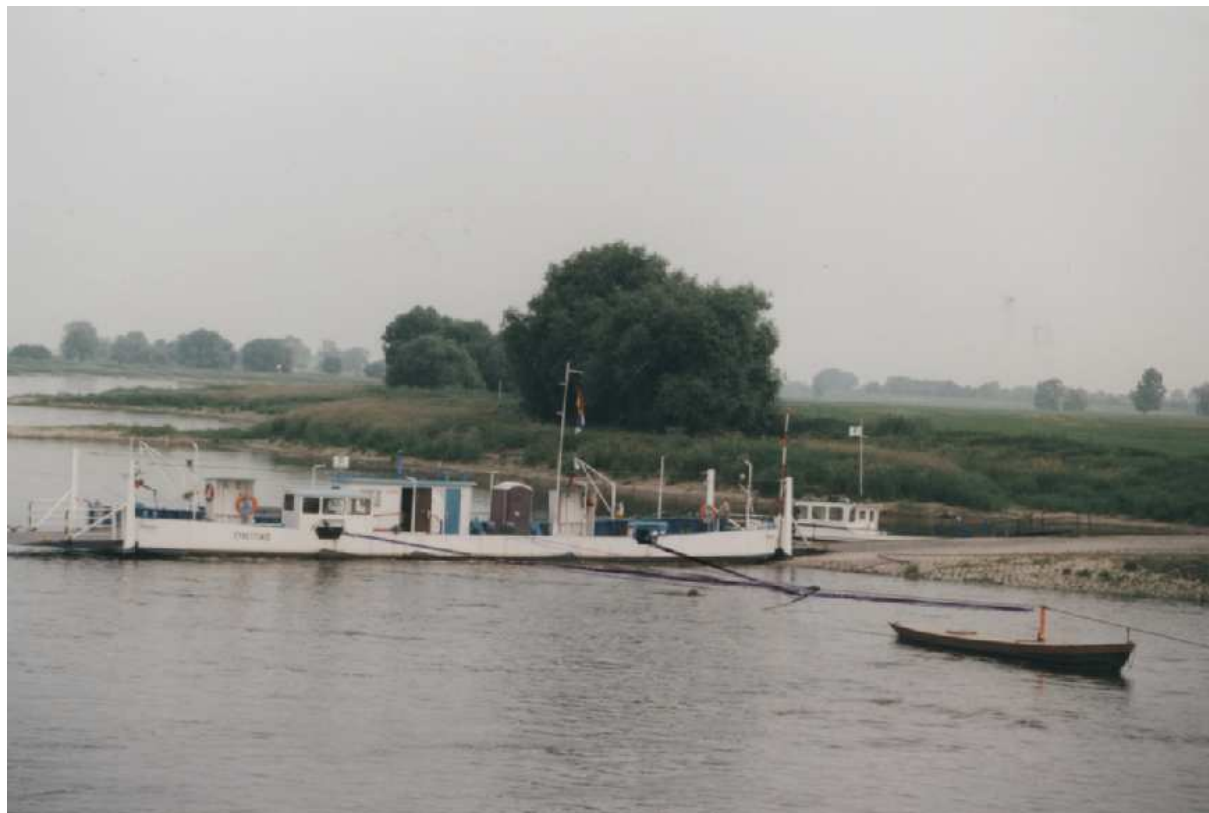
Amarrage avant – arrière du bac à traile de Frettin, sur l'Elbe (D)
