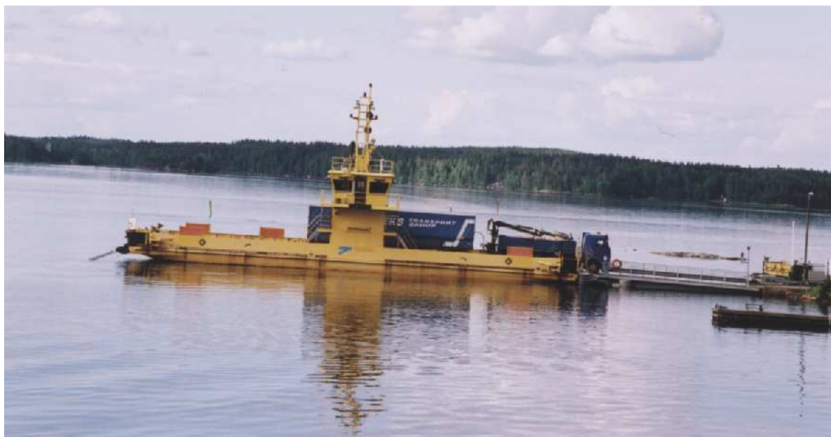
Passeur à câble immergé. Lac de Saimaa (Fin)
