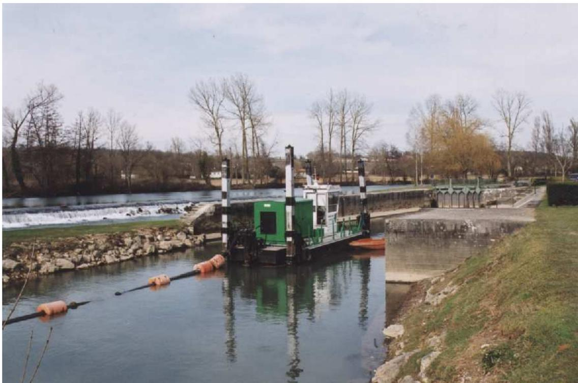
*Sur la Charente, à l'écluse de Lamotte (F-16) un engin de la DDE aspire la boue par de longs tuyaux*
